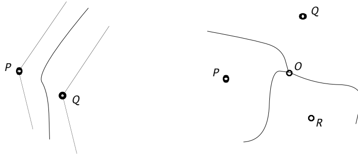
Figura 3.10: Bisector de dos puntos y diagrama de Voronoi de tres puntos.
