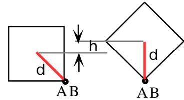
Para que el cubo caiga sobre el lado ABCD, la energía cinética de rotación inicial, tiene que ser superior a la energía potencial necesaria para que el centro de masas pase por el punto mas alto:
