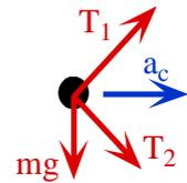
Sustituyendo el valor de  $T_1$  en la ecuación 1.2:  $\frac{ma_c}{\cos(\alpha)} - T_2 \sin(\alpha) - T_2 \sin(\alpha) - mg = 0$
