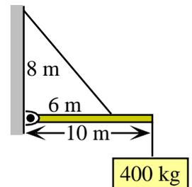
Si el cable lo dejamos sujeto a la pared 8 m por encima de la bisagra, pero permitimos que su longitud varíe de modo que pueda conectarse a la viga a diversas distancias x de la pared:
