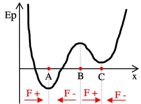
c) móvil solo se puede mover entre A1 y B1 o entre C1 y D1. No tiene energía suficiente para pasar de una región a otra. La partícula está atrapada en un pozo de potencial.
