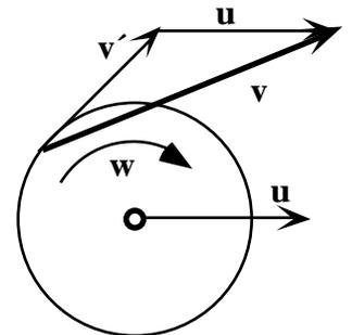
La rueda delantera tiene un momento angular  $L$ . Al inclinarse la rueda hacia la derecha, la normal en el suelo, ejerce un momento respecto del eje que lleva la dirección de avance de la bici.. Recordando que  $M = dL/dt$
