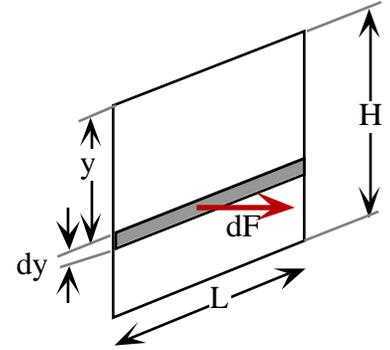
Para calcular la fuerza total sobre la presa debemos integrar  $dF$  entre la superficie del agua y el extremo inferior de la presa:
