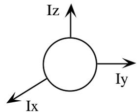
Por simetría,  $I_x = I_y = I_z = I$ . Además,  $I_x = \int (y^2 + z^2) dm$ ,  $I_y = \int (x^2 + z^2) dm$  e  $I_z = \int (x^2 + y^2) dm$ .
