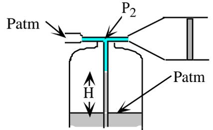
$$P_1 + \rho_{aire} g h_1 + (1/2) \rho_{aire} v_1^2 = P_2 + \rho_{aire} g h_2 + (1/2) \rho_{aire} v_2^2 \Rightarrow$$
