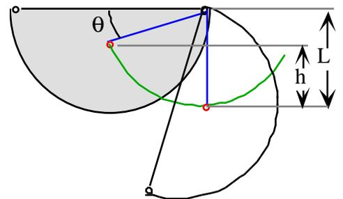
Introduciendo estos valores en la ecuación 5,  $h = 1.086 R (1 - \sin 22.997) = 0.6617 R$ . Sustituyendo este valor en la ecuación 4 y despejando la velocidad angular:
