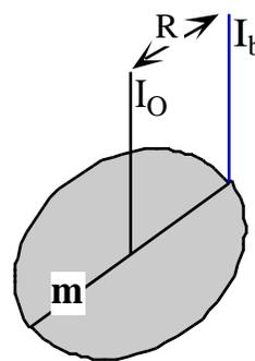
La placa circular es la suma de dos placas semicirculares, tal como muestra la figura por lo que el momento de inercia será la suma de los momentos de inercia de las dos placas:  $I_b = I_{bA} + I_{bB}$ . Por simetría los momento de inercia de las dos placas semicirculares son iguales ( $I_{bA} = I_{bB} = I$ ) por lo que :  $I_b = 2I$ .
