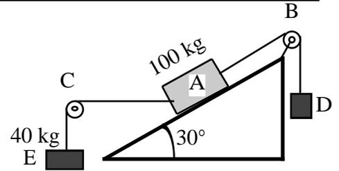
A continuación supongamos que el plano y las poleas son rugosas, siendo el coeficiente de rozamiento entre el plano y el cuerpo A de  $\mu = 0.1$ , el radio de la polea B  $R = 0.1$  m y momento de inercia de la polea B  $I = 0.5$   $\text{kgm}^2$ . Si cortamos la cuerda horizontal AC:
