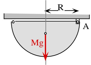
d) Las fuerzas que actúan sobre la placa son el peso y la reacción en A, que la podemos descomponer en dos componentes:  $R_{Ax}$  y  $R_{Ay}$ .
