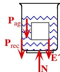
Lo que marca la balanza de platillo en kg es la  $N/g \Rightarrow m_{platillo} = 3.24 \text{ kg}$
