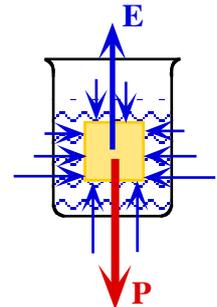
b) Primero calculamos el empuje sobre el bloque de aluminio. Para calcularlo, hay que determinar el volumen del aluminio:  $V_{al} = m_{al}/\rho_{al} = 2 / 2700 = 7.407 \cdot 10^{-4} \text{ m}^3$
