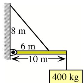
Si el cable lo dejamos sujeto a la pared 8 m por encima de la bisagra, pero permitimos que su longitud varíe de modo que pueda conectarse a la viga a diversas distancias x de la pared:
