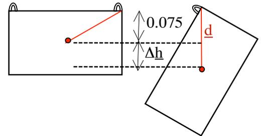
La energía potencial gravitatoria se transforma en energía cinética de rotación:
