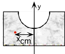
Si hacemos girar la superficie entorno al eje y tal como muestra la figura, se genera un volumen que es el de un cilindro de radio 200 mm menos el de media esfera de radio 100 mm.
