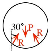
para calcular el ángulo que forma  $R$  con la vertical ( $30^\circ$ ), recordemos que los centros de los 3 cilindros forman un triángulo equilátero, con independencia de cual sea el ángulo  $\alpha$ .
