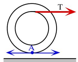
Si suponemos que el punto A trata de moverse (deslizar) en la dirección de la tensión, la fuerza de rozamiento se opone a este movimiento (deslizamiento), por lo que las fuerzas que actúan son las de la figura:
