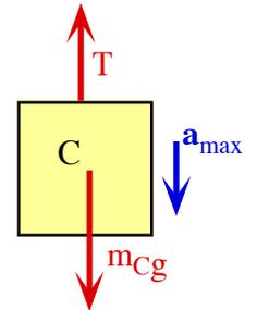
2) Un cilindro homogéneo pesado tiene un masa m y un radio R. Se ve acelerado por una fuerza T que se aplica mediante una cuerda arrollada a lo largo de un tambor ligero de radio r unido al cilindro (ver figura). El coeficiente de rozamiento estático es suficiente para que el cilindro ruede sin deslizar.
