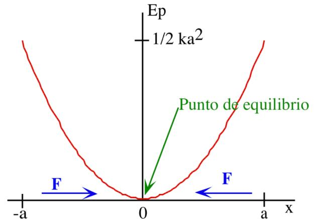
d) La masa oscila entre las posiciones  $-a$  y  $a$  realizando un movimiento armónico simple ( $x = a \sin(\omega t + \theta_0)$ )
