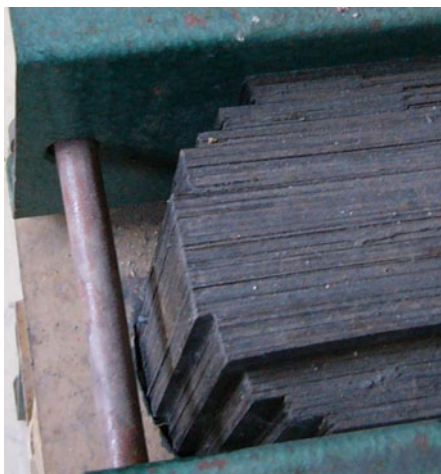
Fig. 4: Detalle de la columna de un transformador trifásico
