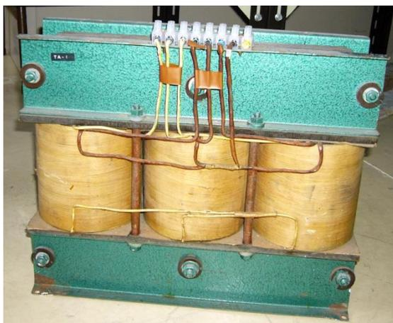
*Fig. 31: Transformador trifásico.*
