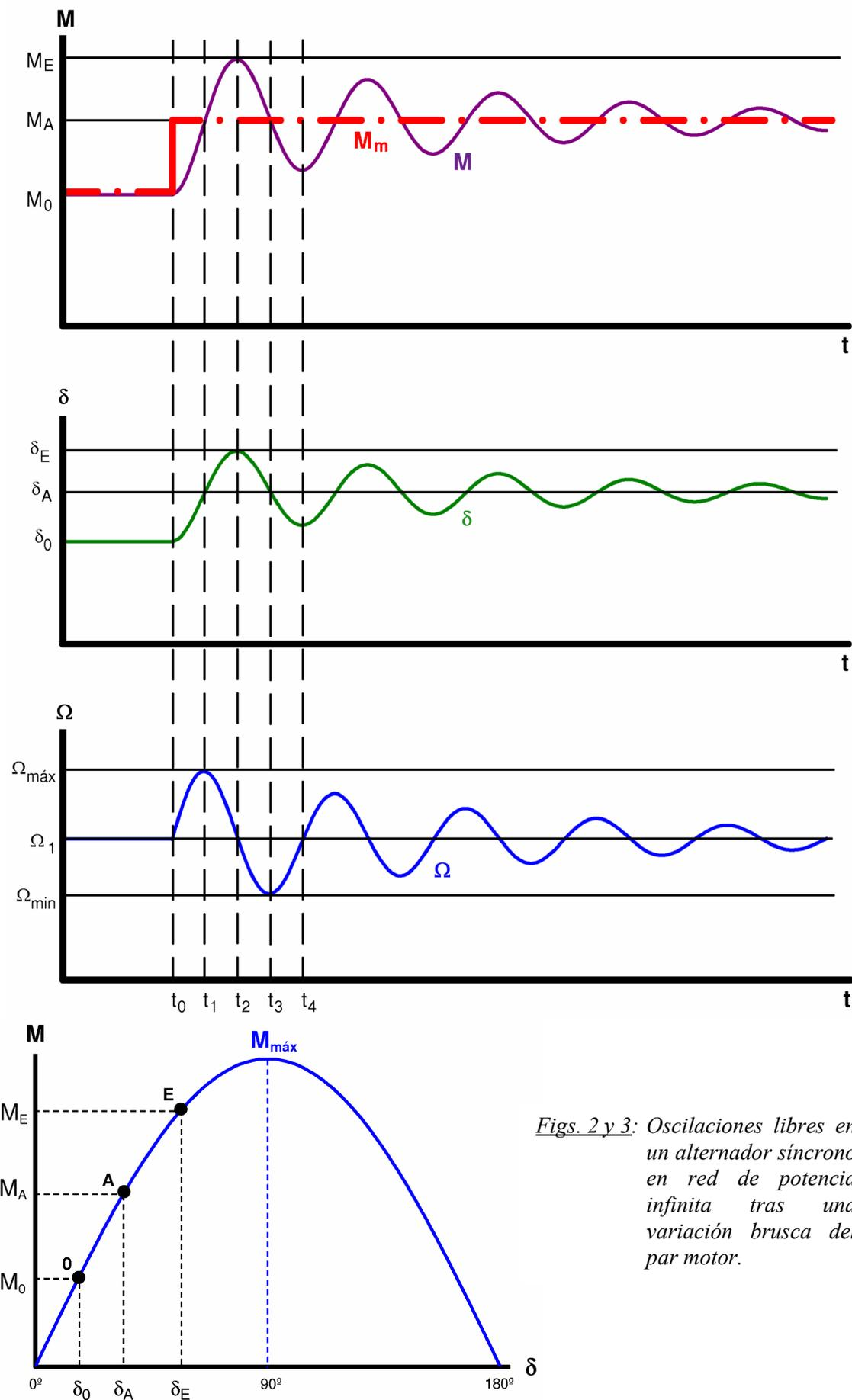
*Figs. 2 y 3: Oscilaciones libres en un alternador síncrono en red de potencia infinita tras una variación brusca del par motor.*
