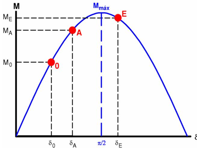
Fig. 4: Funcionamiento estable con  $\delta_E > \pi/2$
