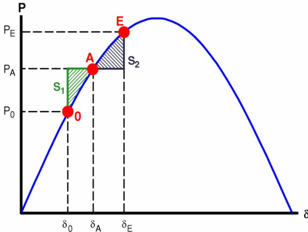
*Fig. 6: Método de igualdad de las áreas*
