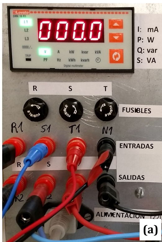
Fig. 12: Módulo con un multímetro digital trifásico (a) y multímetro usado en dicho módulo (b)
