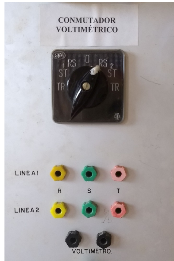
Fig. 11: Módulo con un conmutador voltimétrico
