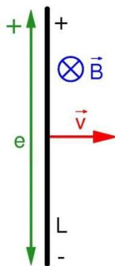
*Fig. 12:* F.e.m. inducida sobre un conductor rectilíneo que se mueve con la velocidad  $\vec{v}$  y es perpendicular a la inducción magnética  $\vec{B}$  (la cuál en esta figura es un vector perpendicular al plano del papel y entrante a éste)
