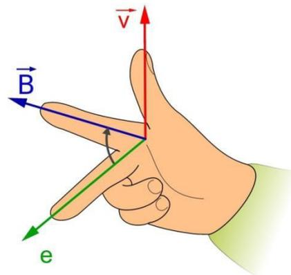
*Fig. 13:* Regla de la mano derecha para determinar el sentido de la f.e.m. inducida sobre un conductor en movimiento. (Imagen modificada de la dibujada por J. F. Melero y que está disponible en Wikipedia Commons)
