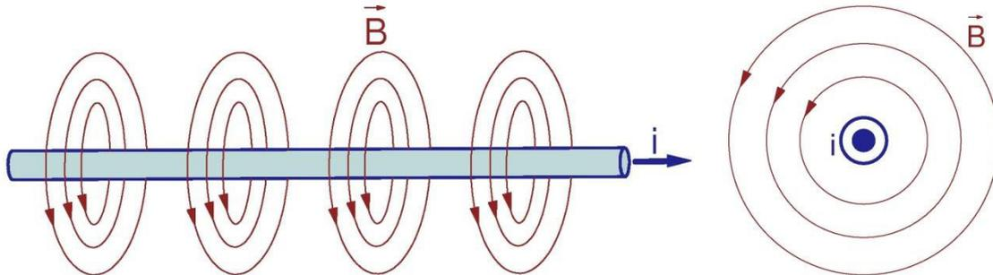
Fig. 4: Líneas del campo magnético originado por un conductor rectilíneo con corriente.
