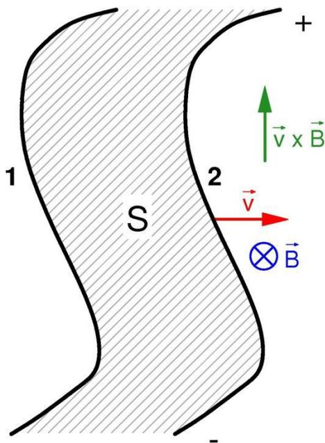
*Fig. 11: F.e.m. inducida y flujo barrido por un conductor que se mueve a la derecha con la velocidad  $\vec{v}$  en el seno de un campo magnético cuya inducción  $\vec{B}$  es perpendicular al plano del papel y de sentido entrante.*
