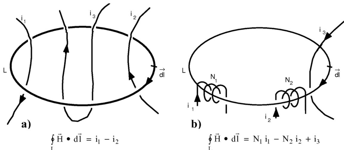
*Fig. 5: Ejemplos de aplicación del Teorema de Ampère.*
