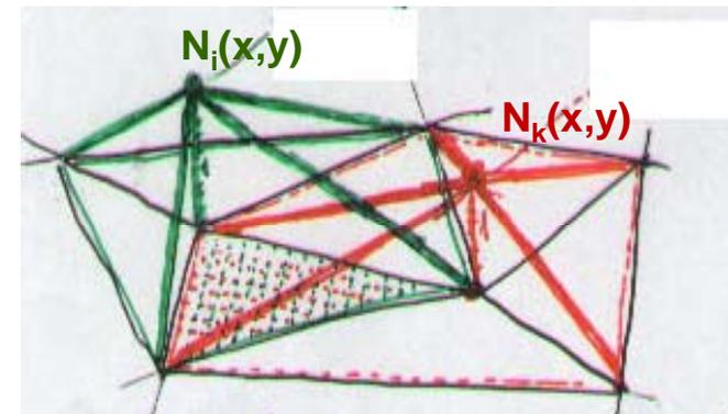
Considérese que el dominio  $\Omega^h$  está formado por E elementos triangulares  $\Omega_e$  y que realizamos una interpolación lineal sobre cada elemento triangular.
