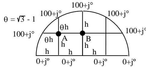
Empleando el método de elementos finitos aproximar la solución utilizando como nodos base iniciales los puntos de la malla de la figura, trazando sobre ella una malla triangular simétrica.
