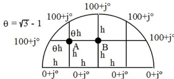
i) Empleando el método de diferencias finitas aproximar la solución en los puntos de la malla de la figura. Escribir en forma matricial el sistema resultante y resolverlo con un programa de ordenador (tomar h=1).
