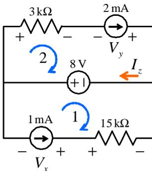
Las resistencias siempre consumen potencia. Sin embargo, las fuentes pueden suministrar o consumir. Para calcular la potencia de cada fuente debemos determinar su tensión y corriente. Por tanto, debemos resolver el circuito.
