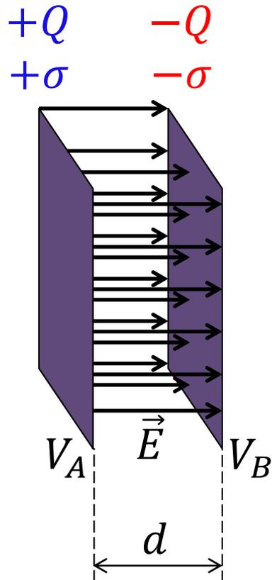
En un condensador, la carga  $Q$  que puede almacenar es directamente proporcional a la diferencia de potencial  $\Delta V$  entre sus placas,  $Q \propto \Delta V$ . La constante de proporcionalidad es la **capacidad**  $C$  del condensador, de forma que  $Q = C\Delta V$ .
