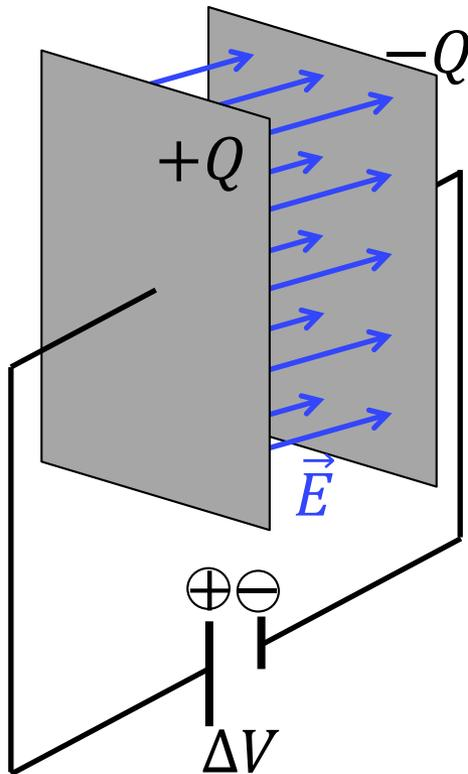
Al conectar las placas a la batería, se establece un campo eléctrico que fuerza a los electrones a moverse hacia la placa del condensador conectada al polo negativo de la batería. Cuando el potencial eléctrico entre la placa, la terminal de la batería y el cable sea el mismo, el movimiento de los electrones cesará. En la otra placa, los electrones se mueven hacia el polo positivo de la batería, quedando cargada positivamente.
