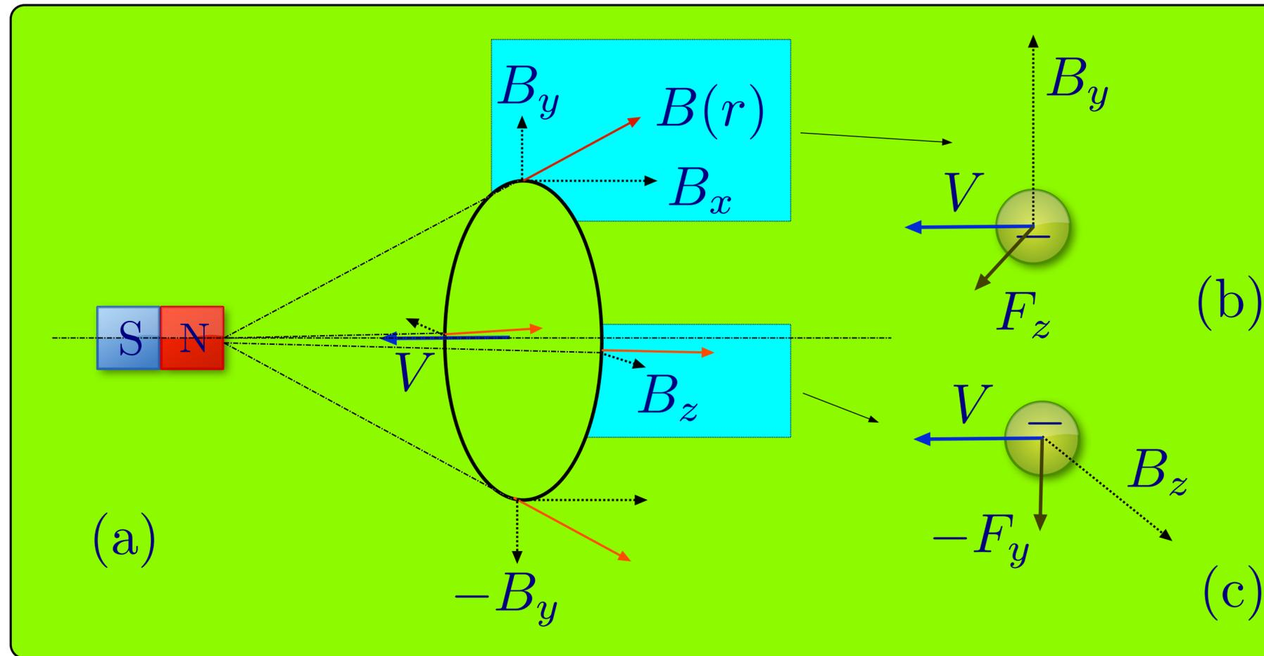
Si un imán se mueve hacia una bobina de varias vueltas de hilo de cobre, que se encuentra en reposo, la aparición de una fuerza electromotriz que mueve cargas en el cobre y produce corriente y energía eléctricas se explica mediante el principio de inducción de Faraday.
