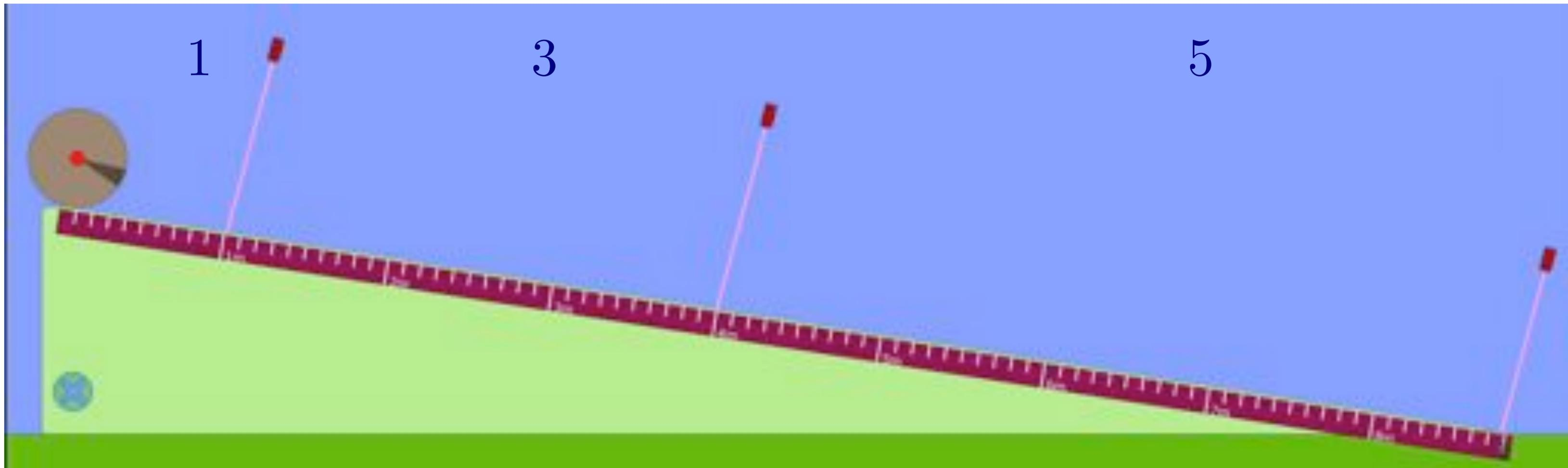
Experimento del descenso de una bola por un plano inclinado.
