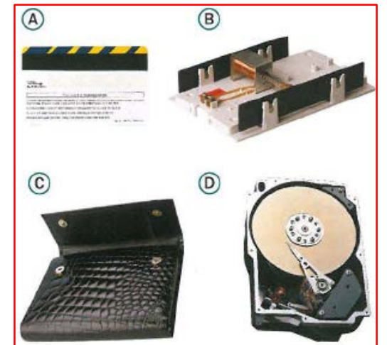
A: Banda magnética en una tarjeta. B: Timbre con un electroimán. C: Cierres magnéticos de una cartera. D: Dispositivo con soporte magnético.
