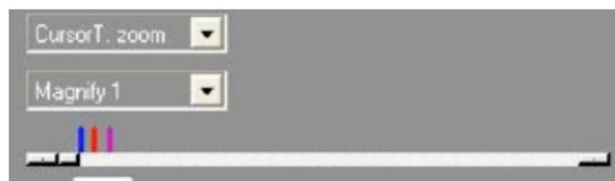
Elegir dos flancos de subida consecutivos en la señal de medida en la pantalla de formas de onda. Situar arrastrando con el ratón la marca A sobre el segundo flanco de subida, la marca T sobre el primer flanco de subida y la marca B en el flanco de bajada entre A y T. Se pueden medir los parámetros temporales del pulso con las marcas A-T (periodo del pulso), A-B (anchura del pulso a bajo) y B-T (anchura del pulso a alto). Las medidas se dan en tiempo, pero
