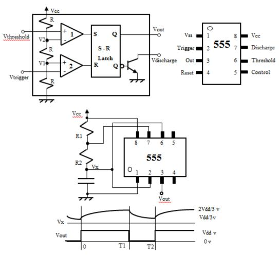
Para ello, basta saber que con unas conexiones como las que se muestran a continuación se genera la temporización de señales de la figura, y que evaluando el funcionamiento del circuito puede calcularse el tiempo que permanece la señal a valor alto (T1) y el tiempo que permanece la señal a valor bajo (T2-T1) como:
