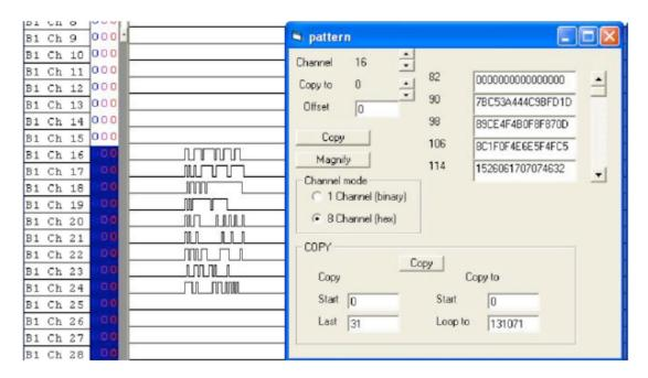
Para cargar los datos en la práctica primero hay que definir la secuencia de datos que se va a cargar, y que se va a programar a partir de la dirección 90 de la ventana *Pattern*. Los datos se muestran en hexadecimal porque así se cargan en la ventana *Pattern*.
