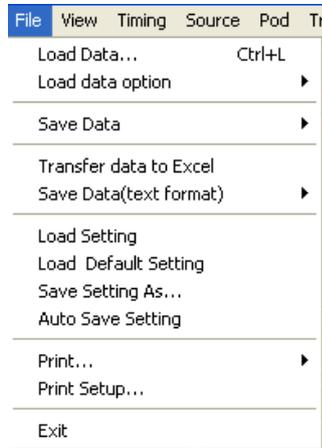
Los comandos *Save Setting* y *Save Data As...* permiten guardar, respectivamente, en un fichero la configuración programada y los datos lógicos que se encuentran actualmente en los canales. Los comandos *Load Setting* y *Load Data* permiten cargar, respectivamente, desde un fichero una configuración y rellenar los datos lógicos de los canales con el contenido de un fichero.
