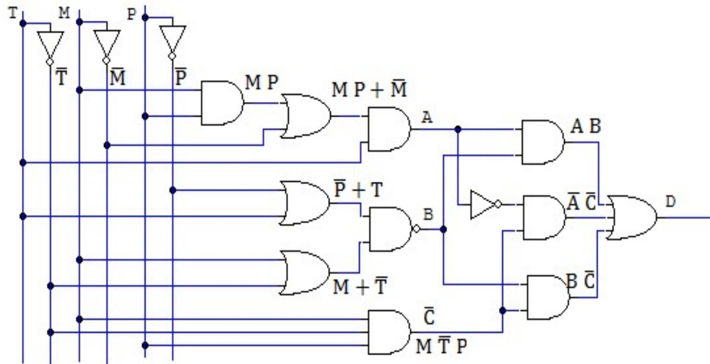
a) Utilizar el álgebra de conmutación para resolver simplificando al máximo posible el resultado de la decisión en función de los factores ambientales, e implementarla con puertas lógicas.
