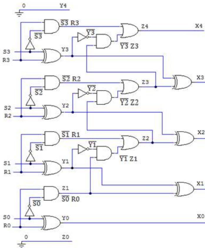
El circuito puede mejorarse, generando directamente  $\bar{Y}_i$  en vez de  $Y_i$ , y que  $X_i = Y_i \oplus Z_i = \bar{Y}_i \oplus Z_i$  usando puertas EXNOR en vez de EXOR, para  $i = 1, 2, 3$  ( $\bar{Y}_1, X_1, \bar{Y}_2, X_2, \bar{Y}_3, X_3$ ), ya que se eliminan las tres puertas NOT que generan  $\bar{Y}_1, \bar{Y}_2$  e  $\bar{Y}_3$ . Queda propuesto.
