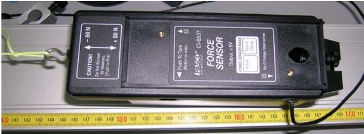
Figura 4. Carro 2 con sensor de fuerza arrastrado a velocidad constante. La superficie inferior roza contra la superficie de la plataforma.
