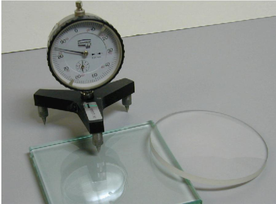
Figura 4: . Esferómetro
