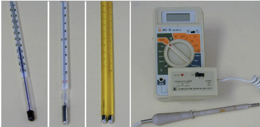
Figura 12: . Termómetros. De izquierda a derecha, de alcohol coloreado, de mercurio y digital.
