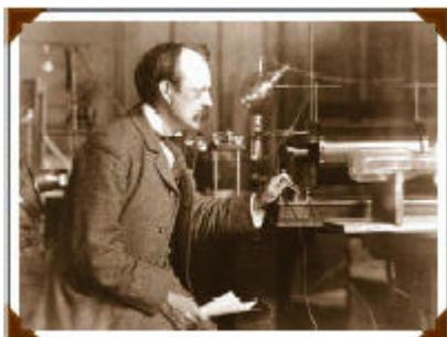
Figura 1: Fotografía de J J Thomson y del dispositivo experimental que diseñó a finales del siglo XIX para medir la relación carga-masa del electrón.
