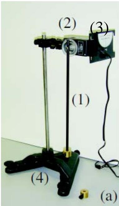
Figura 2: (1) Péndulo físico, (2) sensor de rotación, (3) plomada y escala angular, (4) soporte.
