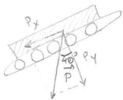
$$\begin{aligned} \text{esta fuerza es } P_x &= mg \cdot \operatorname{sen} 40^\circ \\ &= 50 \text{ kg} \cdot 9,81 \text{ m/s}^2 \cdot \operatorname{sen} 40^\circ \\ &= 315,28 \text{ N} \end{aligned}$$
