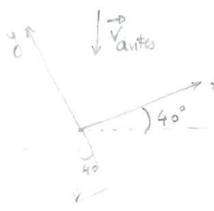
$$v_{\text{antes}, x} = -|\vec{v}_{\text{antes}}| \cdot \sin 40 \text{ m/s} = -4,02 \text{ m/s}$$
