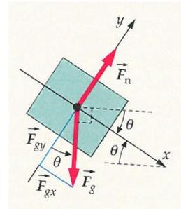
Para determinar  $a_x$  aplicamos a la caja la segunda ley de Newton. Tenemos en cuenta que la normal  $\vec{F}_n$  es perpendicular al eje  $x$  y  $F_g = mg$ :
