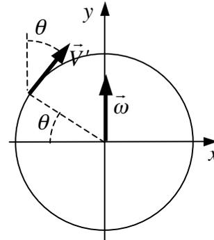
La caja de un ascensor de una mina desciende con una velocidad constante de 12 m/s. Calcular el módulo, dirección y sentido de la aceleración de Coriolis de la caja si el ascensor está situado: a) en el ecuador, b) a  $40^\circ$  de latitud norte, c) a  $40^\circ$  de latitud sur.
