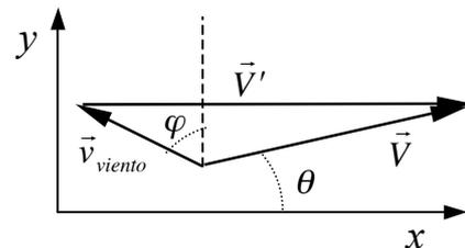
$$\vec{V} = \vec{V}' + \vec{v}_{viento} \Rightarrow \begin{cases} V \cos \theta = V' - v_{viento} \sin \varphi \\ V \sin \theta = v_{viento} \cos \varphi \end{cases} \Rightarrow \begin{cases} \varphi = 31.9^\circ \\ v_{viento} = 85.25 \text{ km/h} \end{cases}$$
