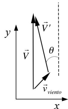
$$\vec{V} = \vec{V}' + \vec{v}_{viento} \Rightarrow \begin{cases} V' \sin \theta = v_{viento} \sin 45^\circ \Rightarrow \theta = 13.1^\circ \\ V = V' \cos \theta + v_{viento} \cos 45^\circ = 300 \text{ km/h} \end{cases}$$
