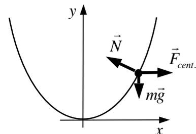
La dirección de la normal la podemos obtener considerando la curva del alambre como una curva equiescalar para un campo escalar bidimensional:  $\Phi(x,y) = x^2 - 2\alpha y$  (en los puntos del alambre se verifica que  $\Phi(x,y) = 0$ ). El gradiente de este campo escalar tendrá una dirección perpendicular a dicha curva. Bastará finalmente por construir un vector unitario  $\hat{n}$  en dicha dirección y con componente  $x$  negativa (ver figura):
