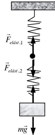
Un sistema se compone de un cuerpo unido por dos resortes al techo. Las constantes elásticas son  $k_1$  y  $k_2$ . Dependiendo de si los dos resortes se utilizan en paralelo o unidos linealmente determinar el trabajo realizado para estirarlos desplazando el cuerpo una longitud  $\Delta l$ .
