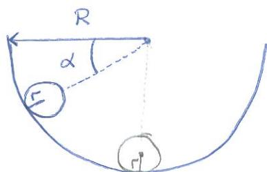
Si no hay rozamiento, la energía mecánica del sistema se conserva.
