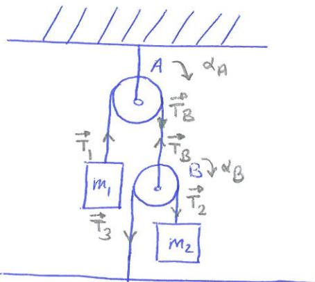
Dibujamos los diagramas de cuerpo aislado para los distintos cuerpos del sistema.
