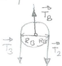
La polea B experimenta un movimiento de translación del centro de masas y otro de rotación alrededor de un eje perpendicular al plano del papel y que pasa por el centro de masas.
