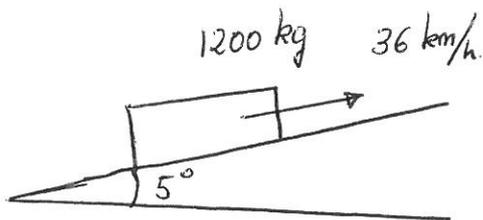
Sólo la componente del peso paralela a la rampa realiza trabajo. Ni la componente perpendicular del peso ni la normal realizan trabajo por ser perpendiculares al desplazamiento.
