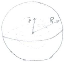
Esta masa produce un campo igual al de una masa puntual  $M'$  situada en el centro de la esfera. Para una esfera uniforme, la fracción de masa total de la esfera que está dentro de  $r$  es igual al
