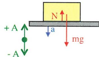
En esa parte (en la parte superior de la oscilación), la  $a = a_{\max}$ . La condición de contacto entre el bloque y la mesa es que la normal sea mayor o igual que cero.
