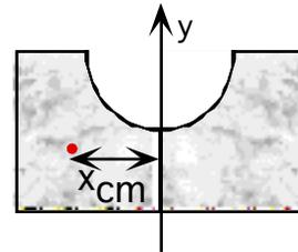
Si hacemos girar la superficie entorno al eje tal y como se muestra en la figura, se genera un volumen que es el del cilindro de radio y alturas iguales a 200 mm, menos el de media esfera de radio 100 mm.
