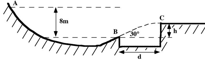
horizontal en el borde C. El ángulo de lanzamiento en B es de  $30^\circ$ . Despreciando la fricción y la resistencia del aire, determinar:
