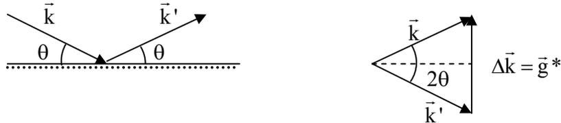
**Figura 3.3.** Esquema de difracción de rayos X en el que se representa la suma vectorial de los vectores de onda incidente (de vector de ondas  $\vec{k}$ ) y difractado (vector de ondas  $\vec{k}'$ ). El ángulo  $\theta$  es el ángulo de Bragg. El triángulo vectorial representa la condición de Laue para la difracción.
