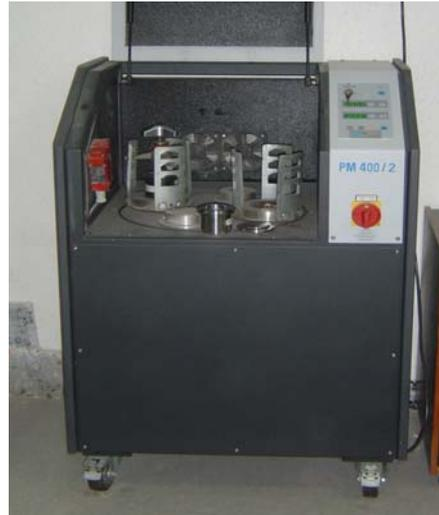
**Figura 3.2.** Esquema de funcionamiento y fotografía del molino planetario de bolas. Los botes y disco en el que se apoyan giran con velocidades angulares  $\omega_v$  y  $\omega_p$ , respectivamente [BECK, 1994].
