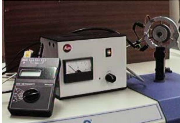
**Figura 3.23.** *Platina calefactora, módulo de control de la temperatura y multímetro para la medida de la temperatura.*
