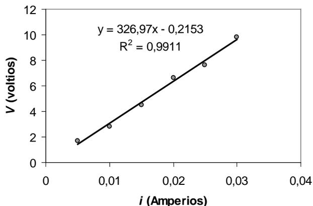
A partir de estos valores se realizan las operaciones indicadas y se obtiene la resistencia  $R = 327 \pm 15 \Omega$
