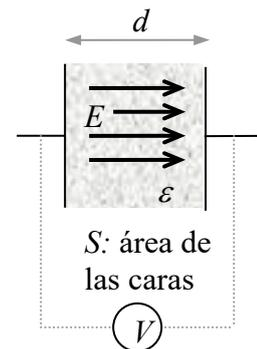
Energía en un condensador =  $\frac{1}{2} CV^2 = \frac{1}{2} Q^2/C = \frac{1}{2} QV$
