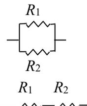
**Potencia eléctrica**  $\left\{ \begin{array}{l} \text{Potencia suministrada* por una batería: } P = \varepsilon i \\ \text{Potencia consumida en una resistencia: } P = V i = i^2 R = V^2 / R \end{array} \right.$
