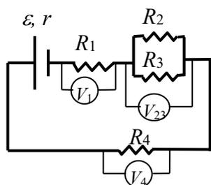
$$\varepsilon = ir + V_1 + V_{23} + V_4 = ir + iR_1 + iR_{23} + iR_4$$
