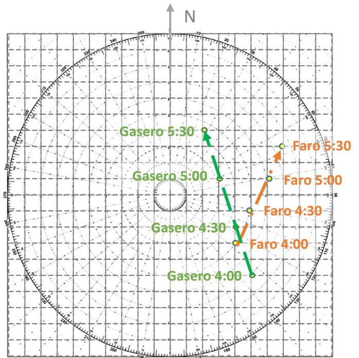
La trayectoria del gasero en el radar del yate es opuesta la del yate en el radar del gasero (p. ej. si a las 4:00 el yate está 5 millas al O y 5 al N del gasero, el gasero queda 5 al E y 5 al S del yate).
