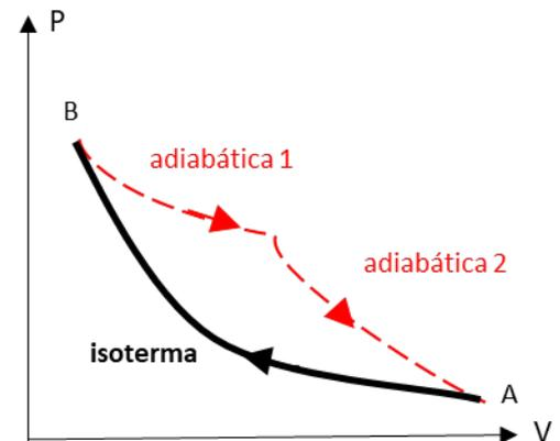
11. Se dispone de un gas ideal diatómico que ocupa un volumen de 1 litro a 1 atm y 300 K. Se desea calentar el gas hasta 600 K, pero no importa el proceso seguido (es decir, P y V no son relevantes, solo se necesita alcanzar 600 K y que no se pierda ni gane gas). ¿Hay algún proceso por el que el gas cede calor, pero se calienta hasta 600 K? En caso afirmativo describirlo y dibujarlo en el diagrama P-V.
