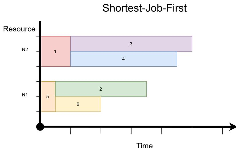
Figura 2.2: Ejemplo de una aplicación del algoritmo SJF para la cola de trabajos de la figura anterior, en un clúster con 2 nodos y 2 cores por nodo.
