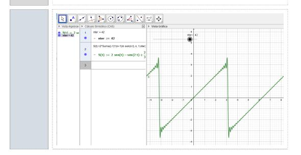
Definición (Desarrollo de una función en serie trigonométrica).- Desarrollar una función f(x) con período  $T=2\pi$  ó T=2p en serie trigonométrica significa hallar una serie trigonométrica convergente, cuya suma S(x) sea igual a la función f(x).
