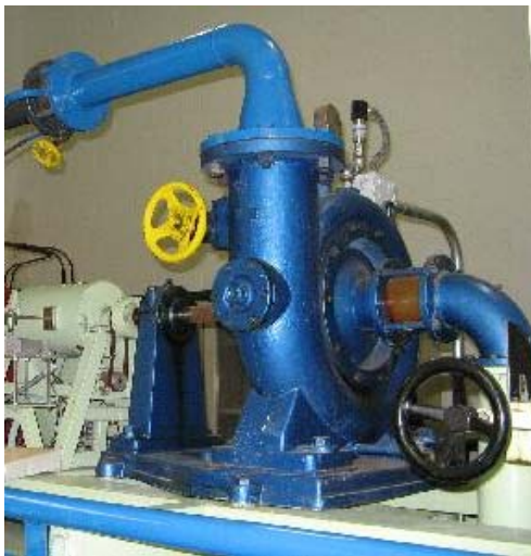
Turbina Francis y detalle del tubo de aspiración
